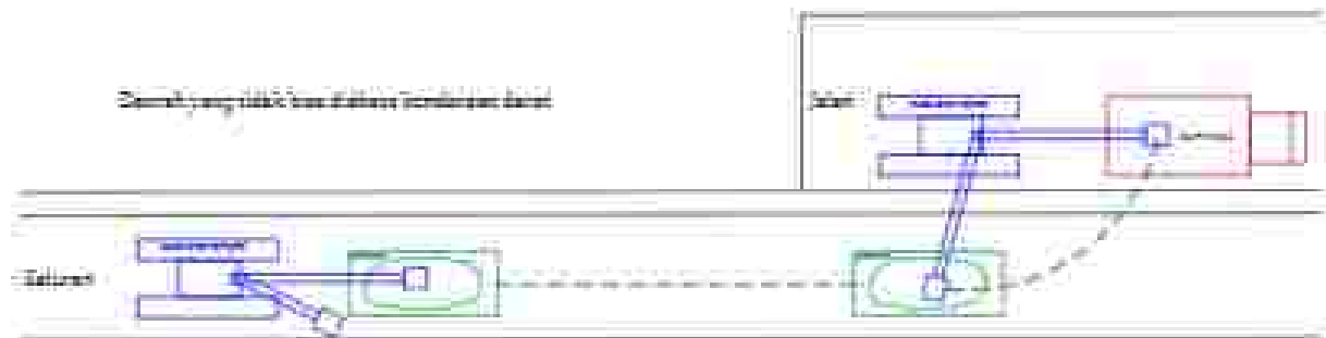
Gambar Error! No text of specified style in document.4. Normalisasi dengan Excavator Ampibi dengan bantuan Ponton, Excavator Darat dan Dump Truck
