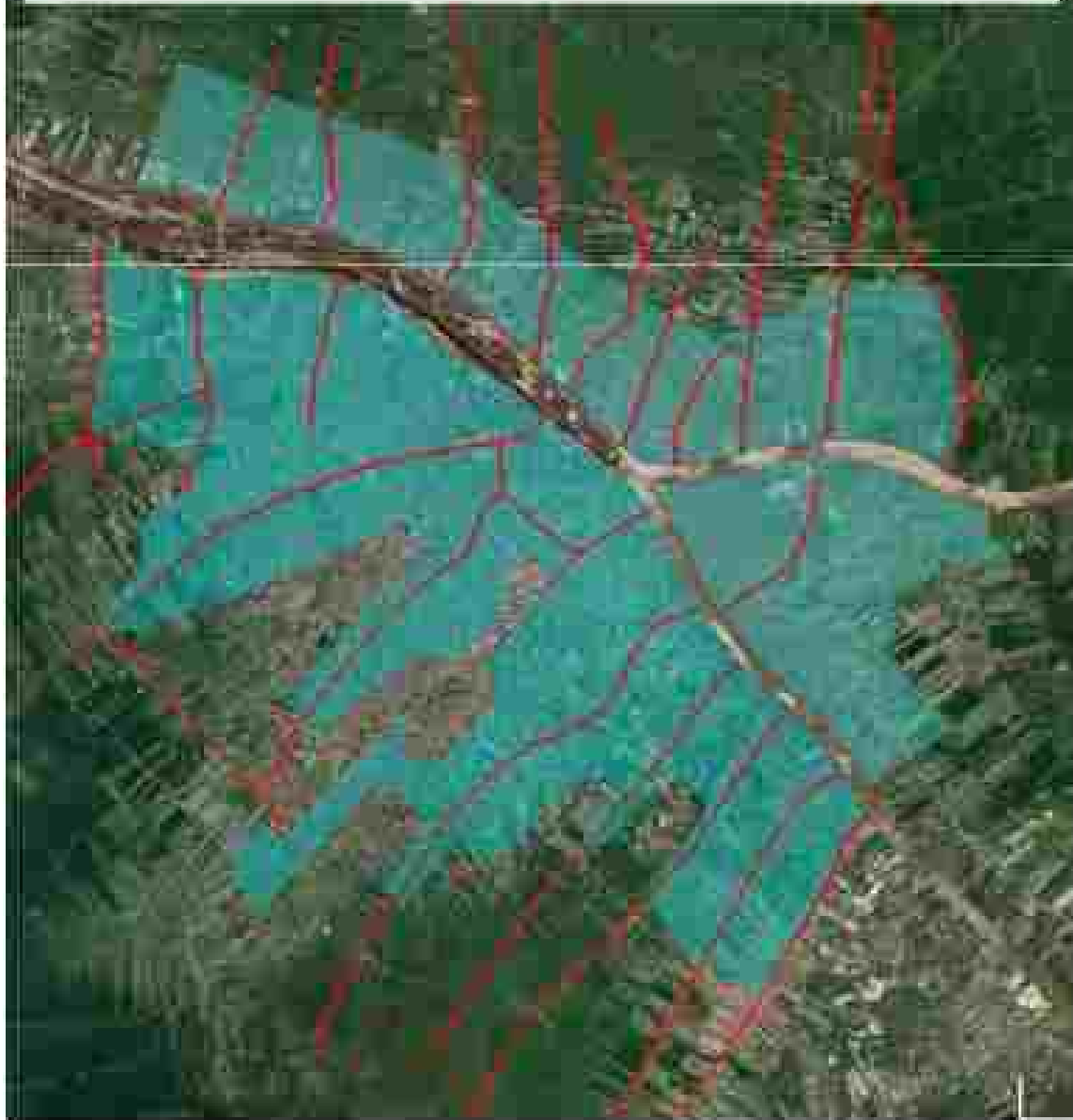
Gambar 2.25. Lokasi Genangan Banjir Kota Pontianak pada 23 Desember 2022 (akibat kombinasi antara hujan lokal (101,3 mm), dan naiknya muka air Sungai Kapuas dan Sungai Landak akibat pasang air laut dan debit dari hulu)
