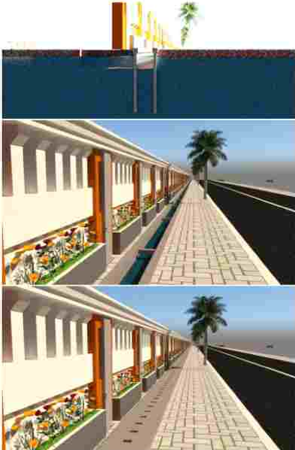
Gambar 4.31. Ilustrasi drainase tersier dengan mini sheet pile
