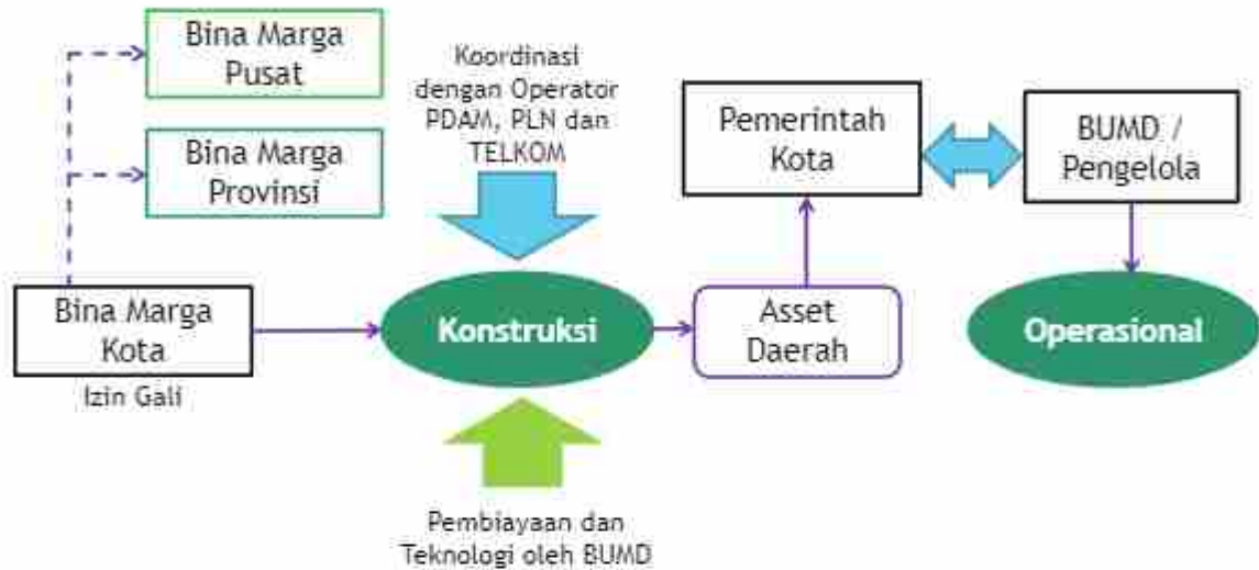
Gambar 5.52. Skema Pembangunan Ducting Bersama
