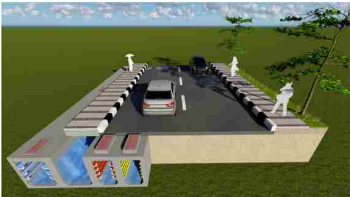
Gambar 5.51. Perspektif ducting dengan drainase 2
