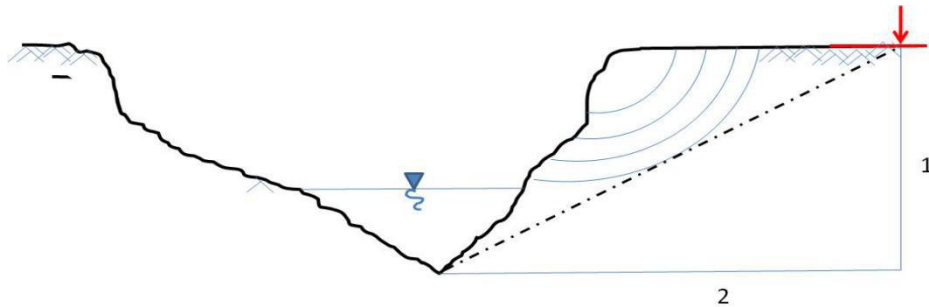
Gambar 5.7 Penentuan Tepi Palung Sungai untuk ruas sungai dengan tebing mudah runtuh
